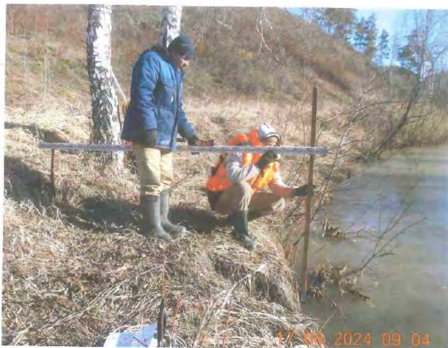
Рисунок 11 – Определение уровня воды в реке по свае поста
