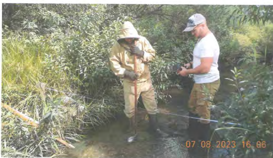
Рисунок 20 – Измерение скорости воды. Вид гидрологического поста «Заказчика»
