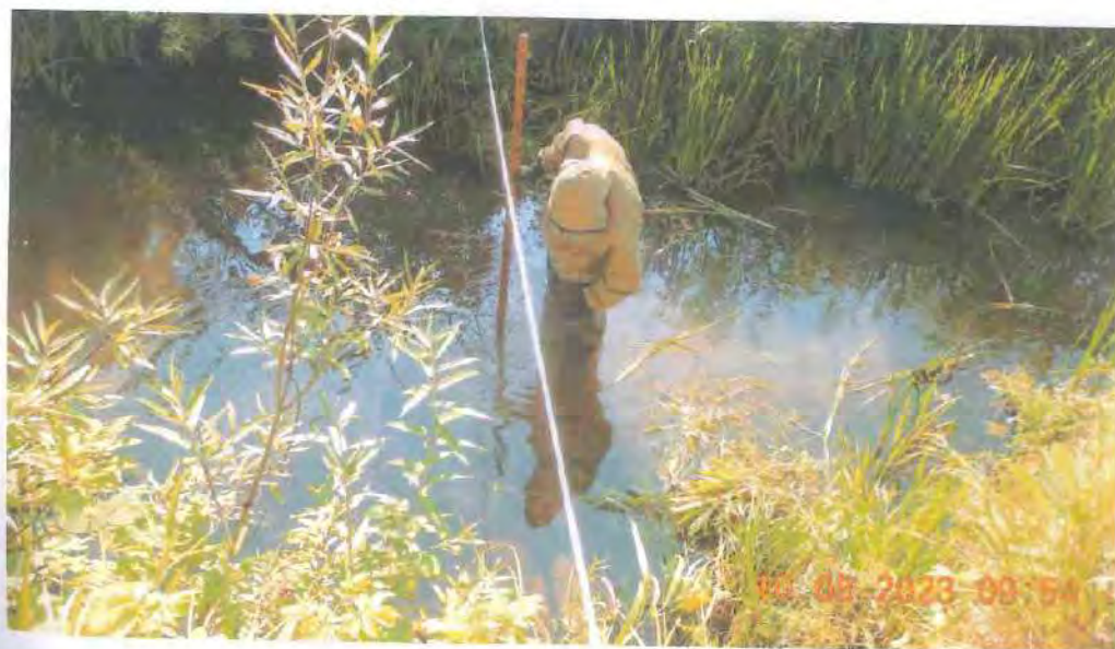
Рисунок 19 – Промер глубин р. Выдриха в створе «Заказчика»
