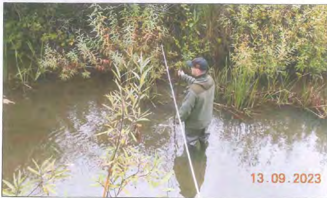
Рисунок 13 – Измерение скорости на верхнем створе р. Выдриха
