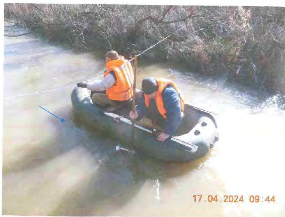
Рисунок 12 – Определение скорости потока вертушкой № 1649 измерительного комплекса
